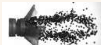
Fotogramas capturados con cámara de alta velocidad tras el disparo de un cartucho con taco dispersante.
